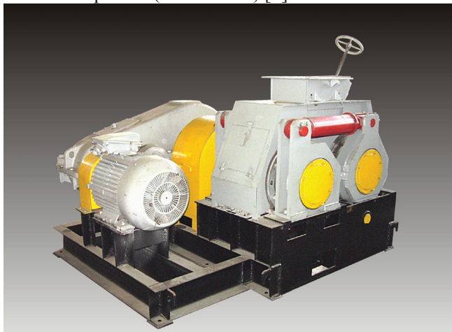
Рисунок. Валковый пресс конструкции ИЧМ для брикетирования мелкофракционных материалов
