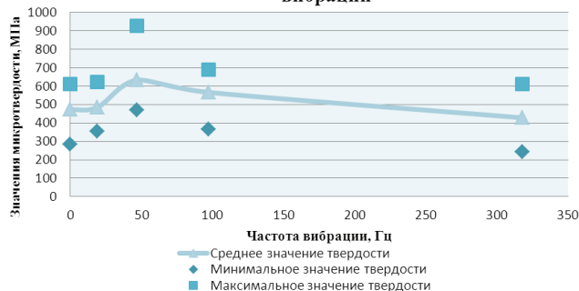
Рис. 7. Зависимость микротвердости Al в эвтектическом сплаве Al-Cu от частоты вибрации в кристаллизаторе
