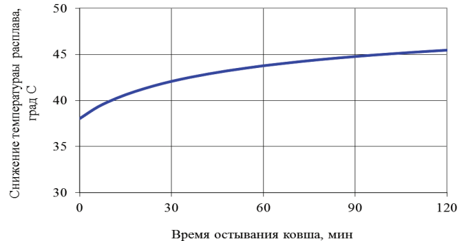
Рис. 3. Зависимость снижения температуры расплава от времени предыдущего остывания ковша
