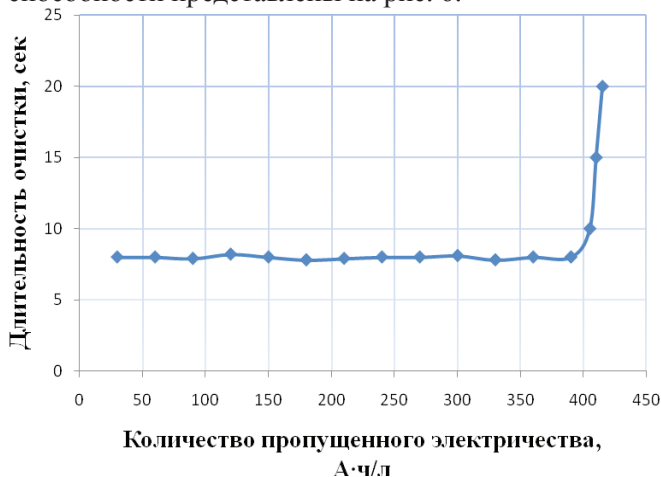
Рис. 6. Зависимость длительности очистки молибдена от количества пропущенного электричества
