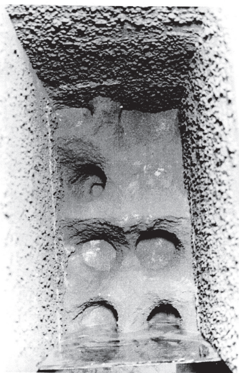
Рис. 1. Воронки, образовавшиеся в насыпной руде, при двухстороннем торцовом выпуске
