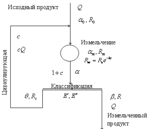
Рис. 1. Схема замкнутого цикла измельчения руд с контрольной классификацией разгрузки мельницы
