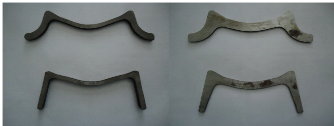
Рис. 6. Поперечное сечение заготовки и раската в калибре для сворачивания при прокатке швеллерных профилей: а – швеллер № 20П, б – профиль U200
