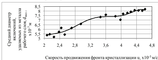
Рис. 3. Зависимость среднего значения диаметра d_{\text{вкл}} включений сульфида марганца (MnS), удаляемых из металла рабочего слоя, от скорости u и продвижения фронта кристаллизации для отливок одного типоразмера
