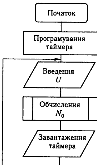
Рис. 5.66. Алгоритм керування широтно-імпульсним стабілізатором
