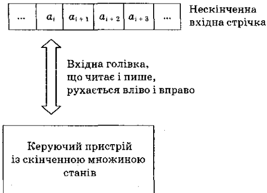
Рис. 9.7. Схема машини Тьюринга
