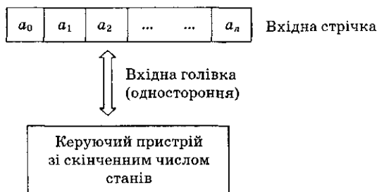
Рис. 9.3. Схема скінченного автомата
