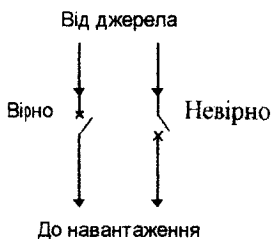
Рисунок 67 - Підведення живлення до комутаційних апаратів
