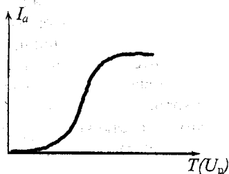
Рисунок 5.2 – Розжарювальна характеристика вакуумного діода
