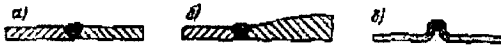
Рисунок 3.7 – Стикове з'єднання зварювальних елементів а – однакової товщини; б – різної товщини; в – з відбортованою крайкою
