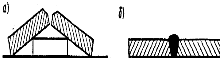
Рисунок 3.16 – Схема використання обернених деформацій при зварюванні: а, в – положення зварювальних деталей до та після зварювання
