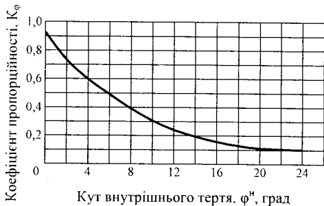
Рис. 4.19. Графік для визначення кута внутрішнього тертя за коефіцієнтом пропорційності K_\phi
