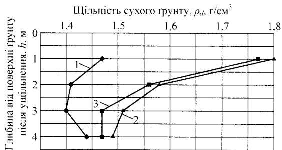
Рис. 14.27. Зміна щільності сухого ґрунту (лесового суглинку та супіску) за глибиною: 1 – в природному стані за даними натурного експерименту; 2 – після ушільнення за моделюванням; 3 – те ж за даними натурного експерименту
