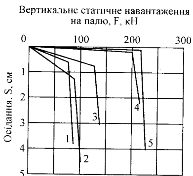
Рис. 15.4. Залежність "осідання-навантаження" при кількості енергії на 1 м.п. палі: 1 – без закріплення; 2 – 9 кв/год; 3 – 18,6 кв/год; 4 – 28,4 кв/год; 5 – 32,4 кв/год
