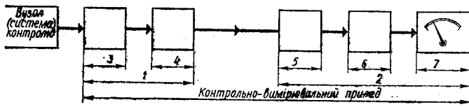
Рис. 13.1. Структурна схема контрольно-вимірвального приладу (покажчика):
