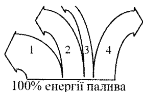
Рисунок 2.24 – Енергобаланс автомобільного ДВЗ: 1 – 40% віддано воді, що охолоджує циліндр; 2 – 25% виноситься вихлопними газами; 3 – 10% тертя; 4 – 25% – корисна робота
