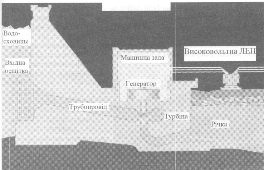
Рисунок 3.14 – Поперечний розріз рівнинної ГЕС пригребельного типу
