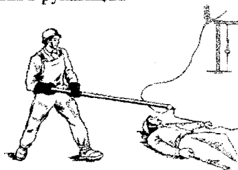
Рисунок 4.16 – Звільнення потерпілого від дії струму в електроустановках напругою понад 1000 В ізолюючою штангою
