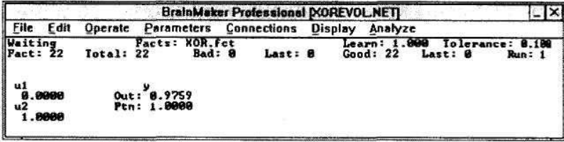
Рис. 3.141. Результат тестування програмою BrainMaker нейронної мережі з рис. 3.11 з початковими значеннями ваг, представленими на рис. 4.139, для u_1 = 0 , u_2 = 1 і d = 1 .
