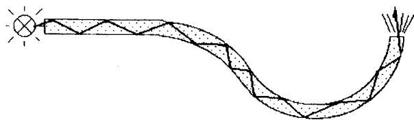
Рисунок 16.2 – Повне відбиття в оптичних стержнях
