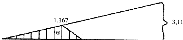
Рисунок 1.3.7 – Побудова ліній впливу поздовжніх сил в трьох стержнях ферми
