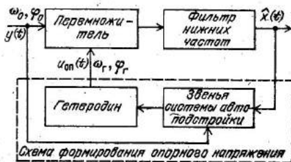
Рис. 5.8. Структурная схема синхронного демодулятора АМ сигналов
