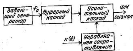
Рис. 4.6. Схема получения ФМ сигнала изменением реактивного импеданса усиленной ступени
