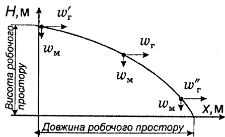
Рис. 8.33. Траєкторія руху частиночок матеріалу в супутному горизонтальному потоці
