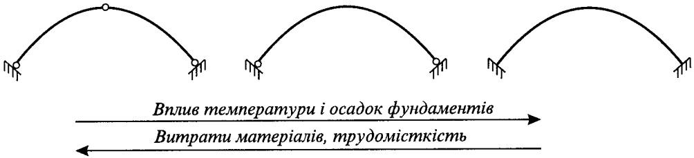
Рис. 2.12. Порівняння різних статичних схем арок
