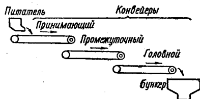
Рис. 6.4. Схема конвейерной линии, состоящей из трех конвейеров
