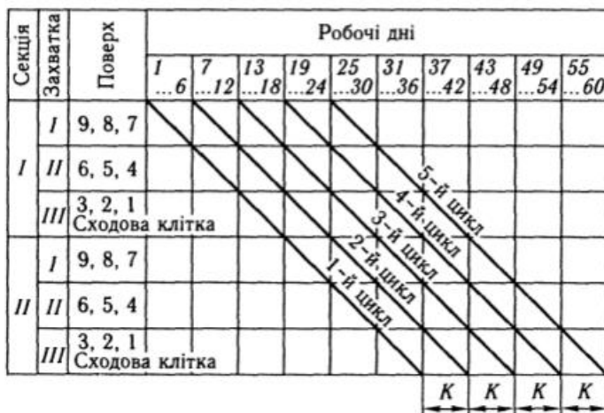
Рис. 3.37. Схема організації опоряджувальних робіт потоково-циклічним методом
