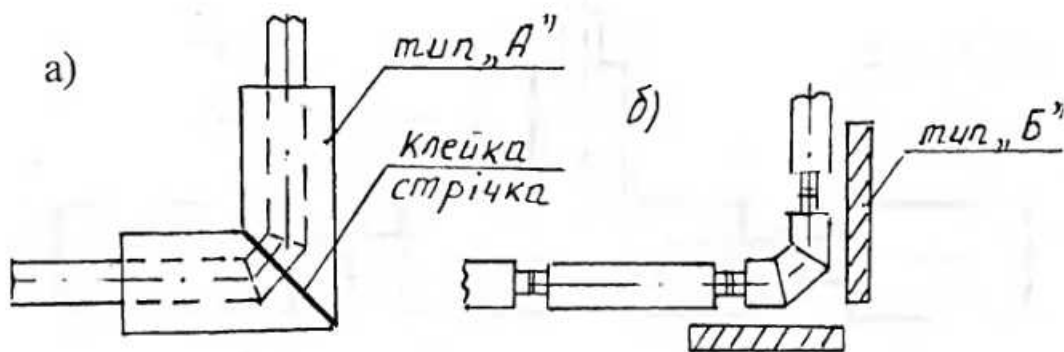
Рис.12.24. Встановлення компенсаційних подушок в місцях повороту теплопроводу
