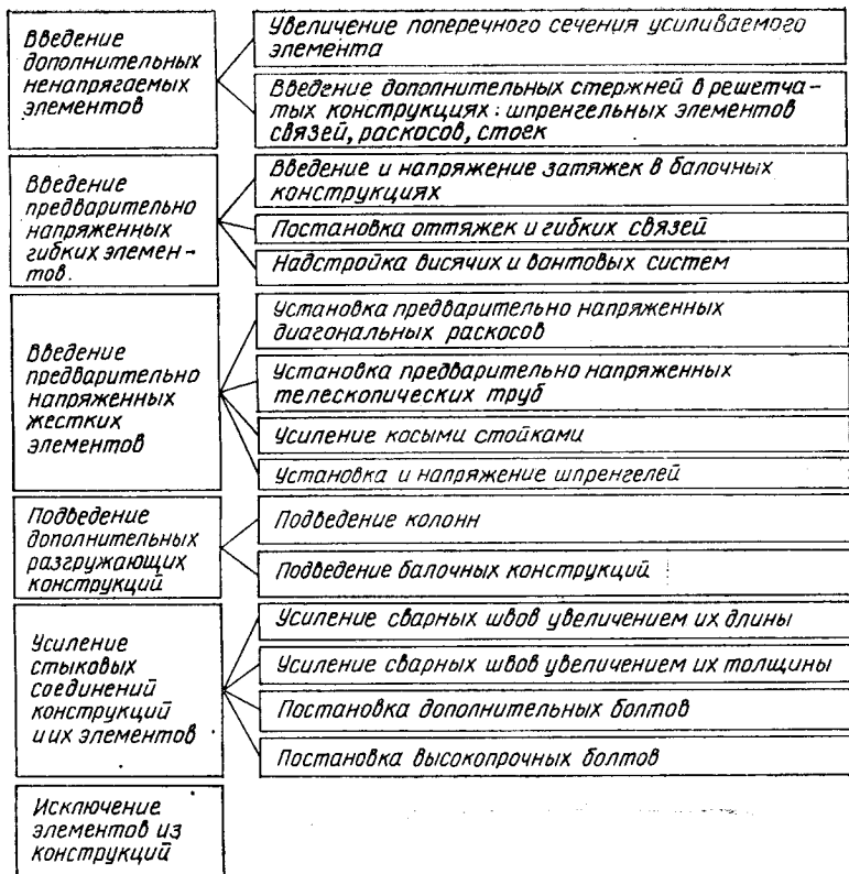
Рис. 7.8. Классификация методов усиления металлических конструкций
