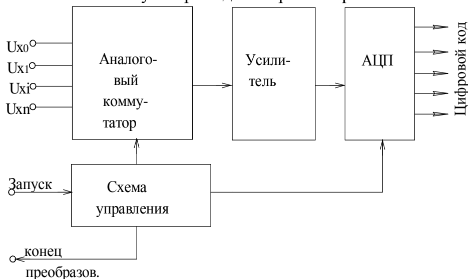
Рис 173. Многоканальный АЦП.
