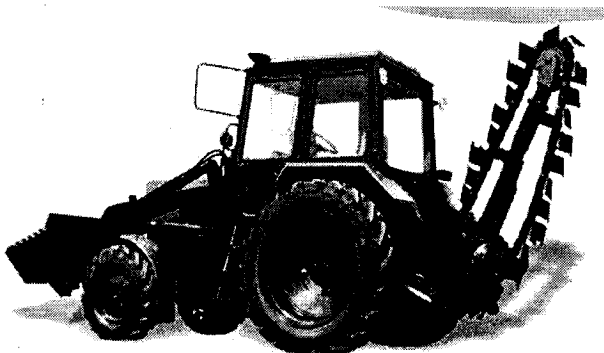
Рис. 6.12. Екскаватор із скребковим робочим органом ЕЦУ-150
