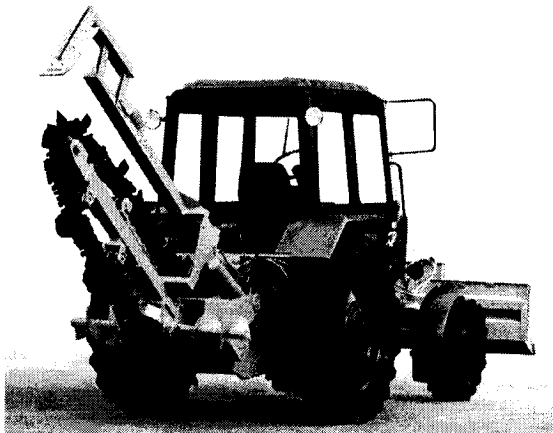
Рис. 6.11. Траншейний ланцюговий екскаватор ЕТЦ-1613
