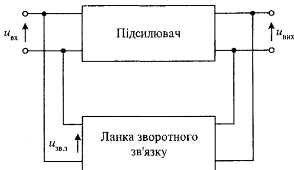
Рис. 42. Структурна схема підсилювача зі зворотним зв'язком
