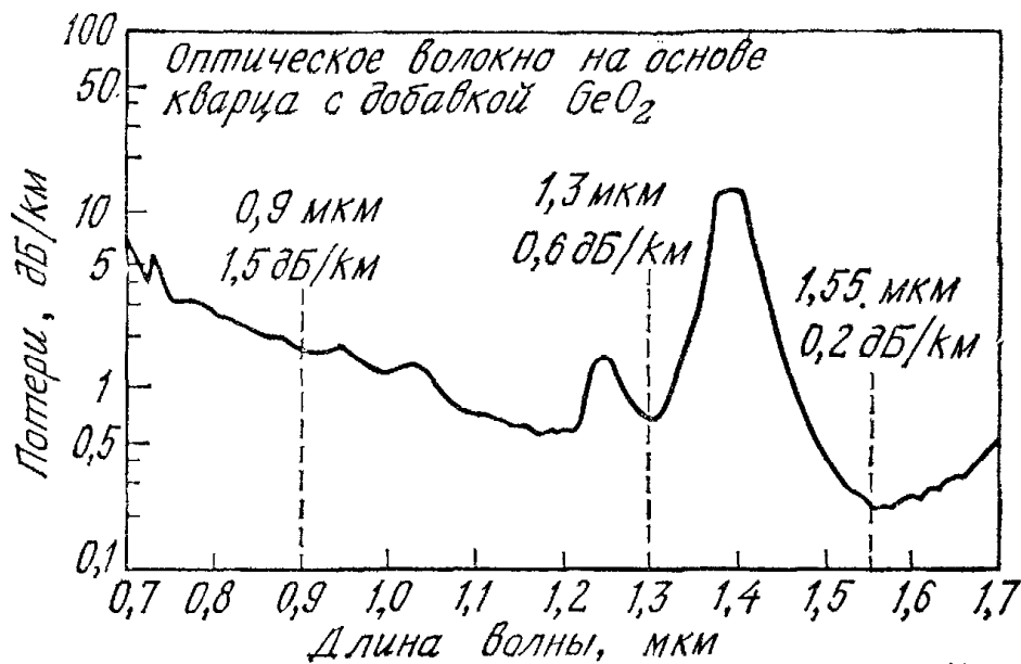
Рис. 22. Зависимость потерь от длины волны излучения в кварцевом волокне. Обозначены три значения длины волны, представляющие наибольший интерес [43].
