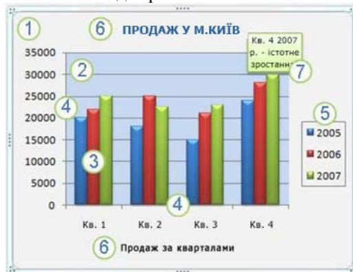
Рис. 4.20. Елементи діаграми: 1. Область діаграми. 2. Область побудови. 3. Точки даних рядів даних, нанесених на діаграму. 4. Горизонтальна вісь (вісь категорій) і вертикальна вісь (вісь значень), уздовж яких відкладаються дані на діаграмі. 5. Легенда діаграми. 6. Назви діаграми та осей, які можна використати на діаграмі. 7. Підпис даних для позначення окремої точки в ряді даних.
