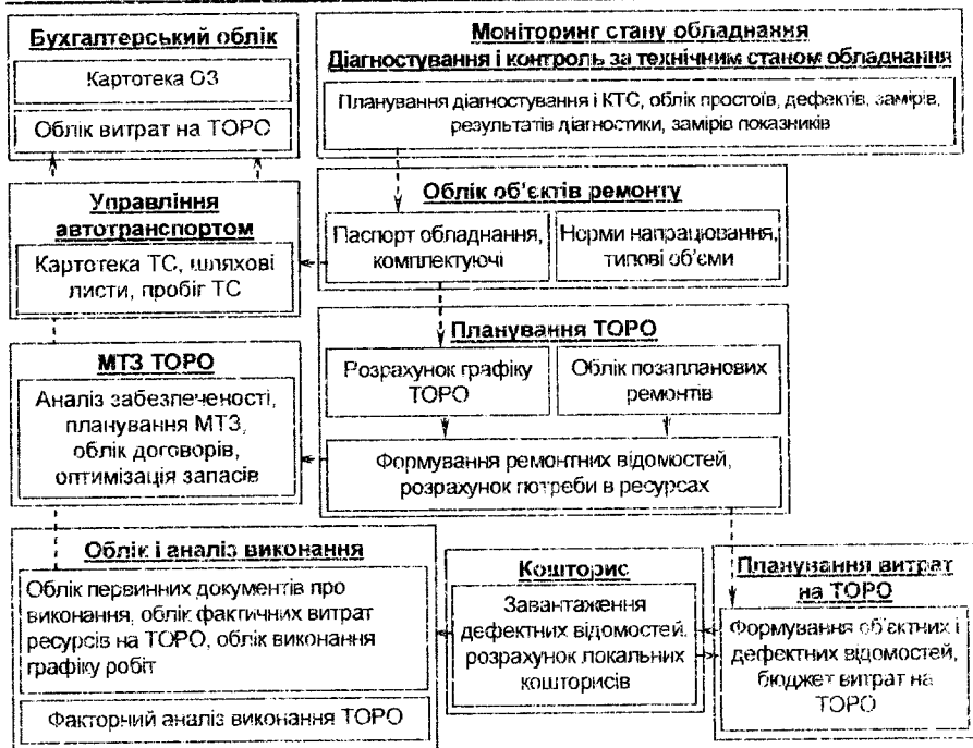
Рис. 9.1. Загальна схема роботи модуля “Управління ТОРО” в системі “Галактика ERP”
