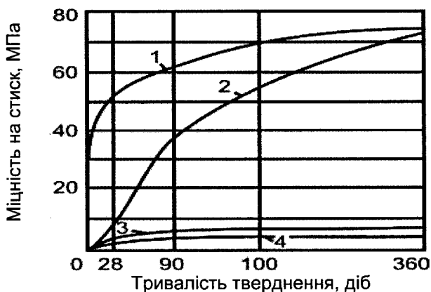
Рис. 7.8. Кінетика зростання міцності мономінерального каменю в часі: 1 - C_3S ; 2 - \beta - C_2S ; 3 - C_3A ; 4 - C_2(A, F)
