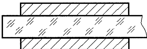
Рисунок 4.6 – Конденсатор, що створений двома обкладками і підкладкою як діелектрик
