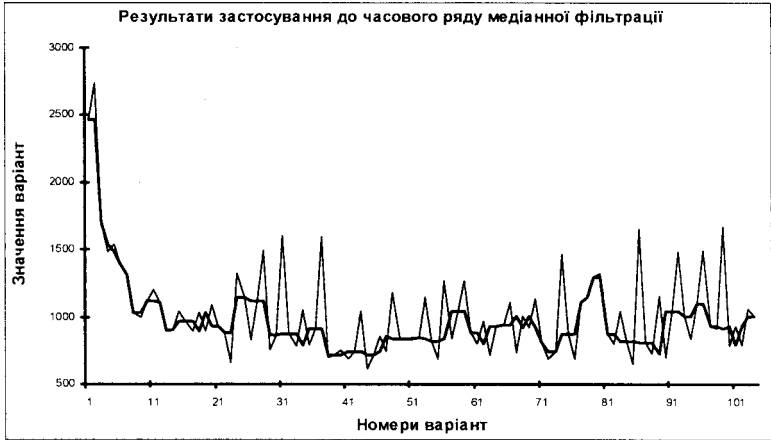
Рис. КП.9. Ефективність застосування медіанної фільтрації.
