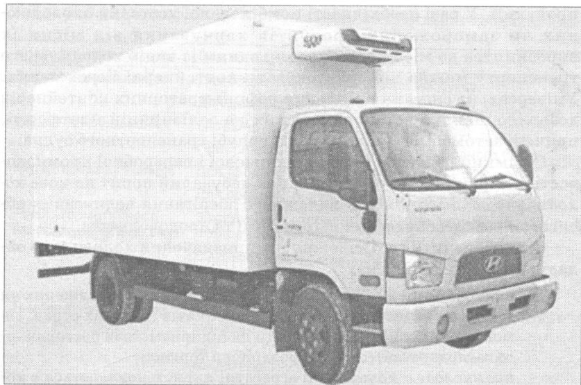
Рис. 3.3. Рефрижераторна установка «Вьюга – Оптима» для середньотонажного автомобіля з фургоном до 20 м 3
