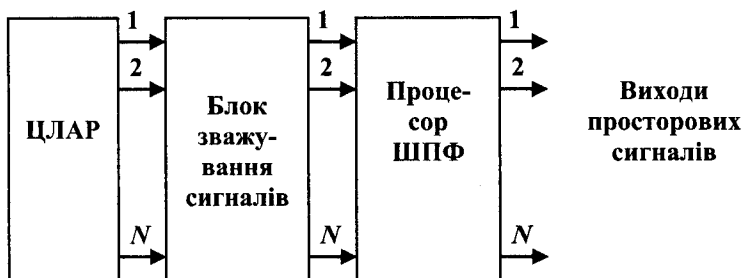
Рис. 7.6. Блок-схема системи ЦОС, що забезпечує формування парціальної діаграми спрямованості ЦЛАР
