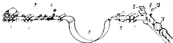
Рис. 7.48. Схема виготовлення спіральшовних труб
