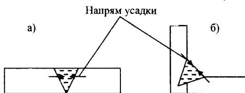
Рис.3.7. Термічна усадка металу зварного шва
