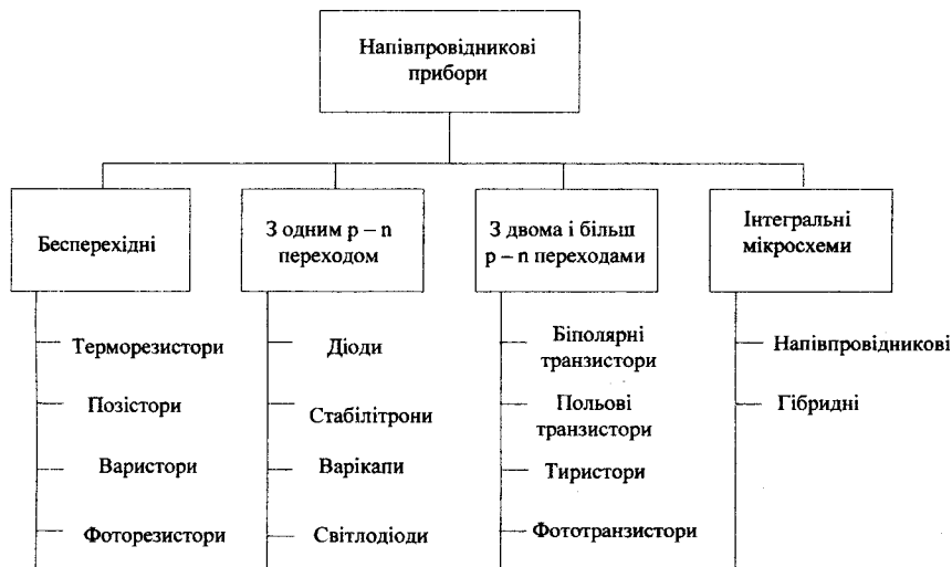
Рисунок 1.28 – Класифікація напівпровідникових електронних приладів
