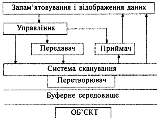
Рис. 1.28. Блок-схема, що показує зв'язок між основними вузлами ехо-імпульсних діагностичних систем.
