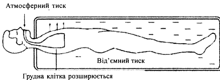
Рис. 6.20. Штучна вентиляція легень з негативним тиском. Апарат “Залізні легені”.
