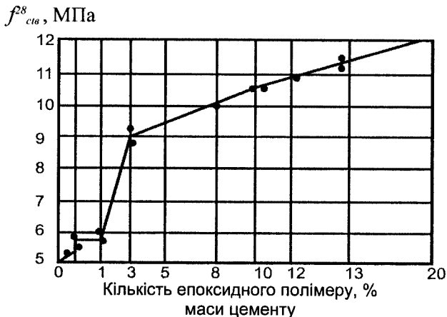
Рис.3.14. Графік для визначення витрати епоксидного полімеру в полімерцементних бетонах
