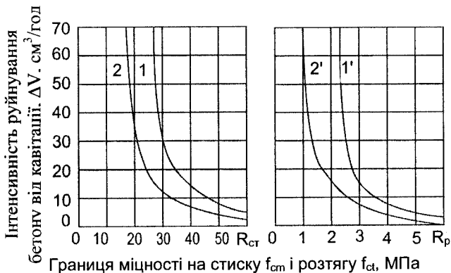
Рис.2.21. Залежність інтенсивності кавітаційного руйнування цементного бетону від його міцності при стиску 1, 2 і розтягу 1', 2'.
