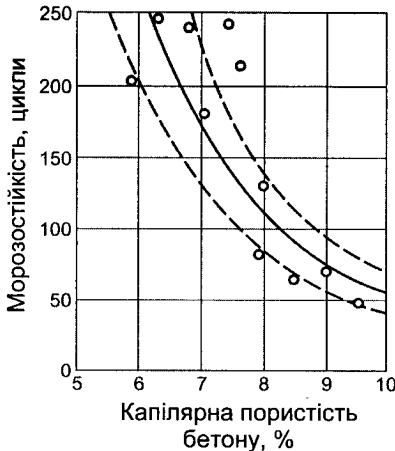
Рис.2.17. Залежність морозостійкості бетону від капілярної пористості (за Г.І. Горчаковим)
