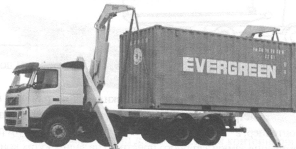
Рис. 2.17. Види самонавантажувальних причепів-контейнеровозів
