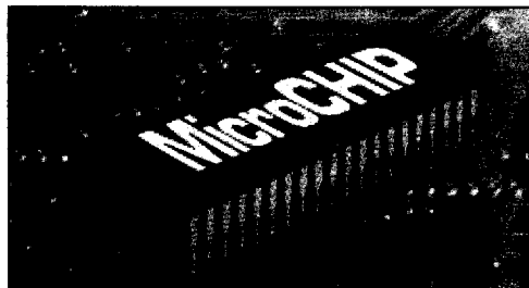
Рис. 1.7. Внешний вид микроконтроллера PIC в DIP-корпусе
