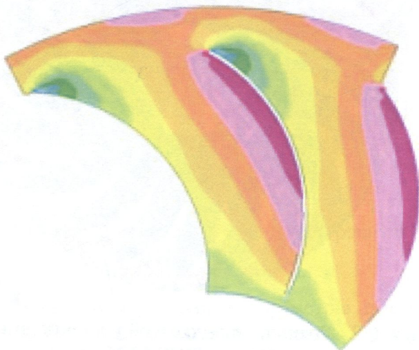
Рисунок 2.3 - Розподіл тисків у ЗНА (ANSYS CFX)
