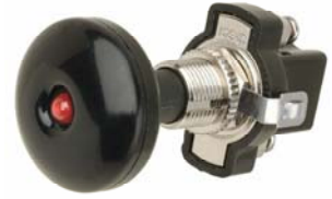
Рис. 4.74. Кнопковий перемикач з фіксацією положення кнопки після натискання та поверненням у початковий стан витягуванням кнопки (push-pull switch)
