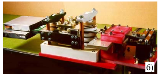
Рис. 1.71. Принципова електрична схема головного кола швидкодіючого гібридного відмикача постійного струму (а) та зовнішній вигляд макетного зразка (б) такого відмикача (Jean-Marc Meyer, Alfred Rufer – Laboratory of Industrial Electronics, Swiss Federal Institute of Technology, Lausanne):
