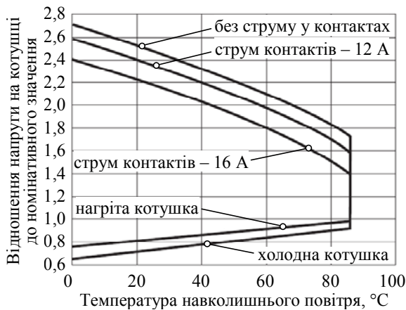
Рис. 4.59. Межі типового робочого діапазону вхідної напруги електромагнітного неполяризованого моностабільного реле
