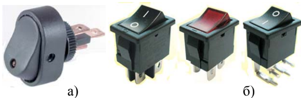
Рис. 4.70. Клавішні (кулісні) вимикачі (rocker switch): а – однополюсний вимикач для кіл живлення побутових електроприладів з монтуванням на плоскій панелі або корпусі приладу та підсвічуванням у розімкненому стані; б – приклади двополюсних вимикачів для кіл живлення електроприладів
