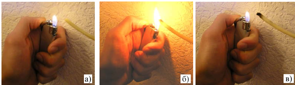
Рис. 3.4. Дія полум'я на компонент (ізоляційну оболонку), що не підтримує горіння: а – зовнішнє полум'я підводиться до оболонки; б - зовнішнє полум'я прикладається до оболонки, оболонка займається; в – полум'я відводиться від оболонки, оболонка згасає.
