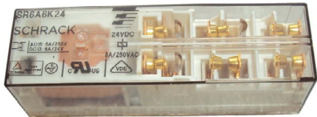
Рис. 2.26. Електромагнітне реле, яке забезпечує гальванічне розділення кіл, але не задовольняє вимогам щодо функції роз'єднання
