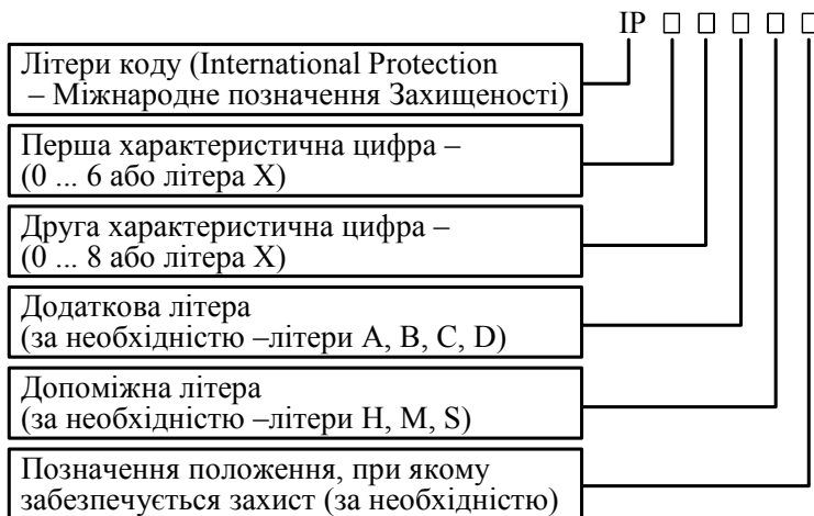
Рис. 2.29. Структура коду ІР (літеру X записують, якщо нема необхідності нормувати характеристичну цифру)
