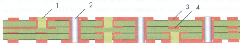
Рис. 1.17. Структура МПП попарного прессования: 1 — переходное металлизированное отверстие между наружным и внутренним слоем; 2 — сквозное металлизированное отверстие; 3 — проводник наружного слоя; 4 — проводник внутреннего слоя.
