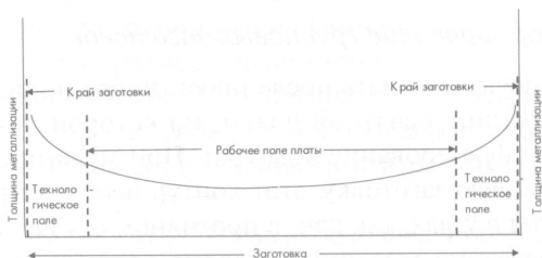
Рис. 6.9. Неравномерность металлизации заготовки от краев к центру
