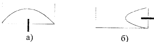
Рис. 5.8. Селективне збудження різних типів хвиль у прямокутному хвилеводі: а) хвилі H_{10} ; б) хвилі H_{01}
