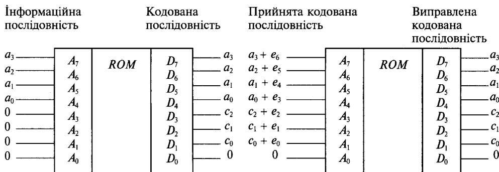
Рис. 39. Схема кодування та декодування з використанням постійного запам'ятовувального пристрою
