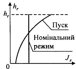
Рисунок 4.39 – Розподіл густини струму ротора по висоті заглибленого паза ротора асинхронного двигуна
