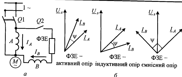
Рисунок 4.60 – Електрична схема (а) та векторні діаграми при різних фазозсувних елементах (б) однофазних асинхронних двигунів
