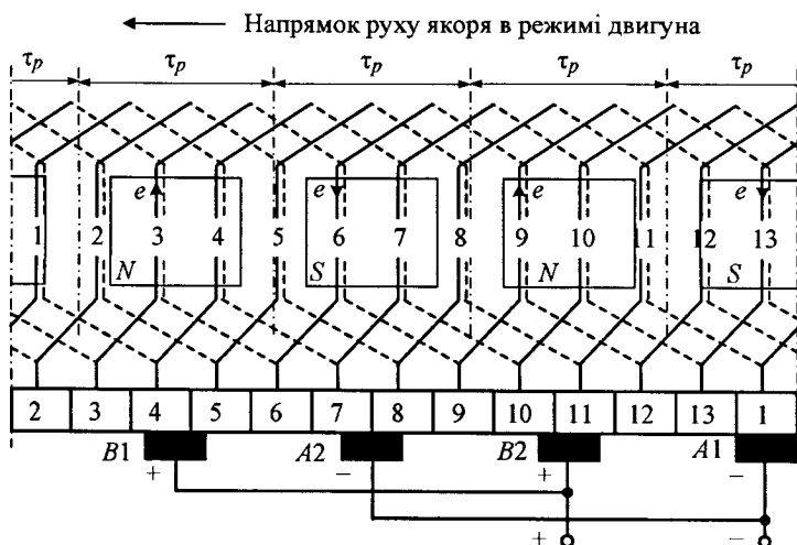
Рисунок 6.21 – Схема-розгортка простої хвильової обмотки якоря на 13 пазів чотириполосної машини постійного струму
