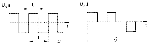
Рис. 6.30. Типові режими широтно-імпульсної модуляції (ШІМ): а – ШІМ з різнополярними імпульсами; б – ШІМ з однополярними імпульсами
