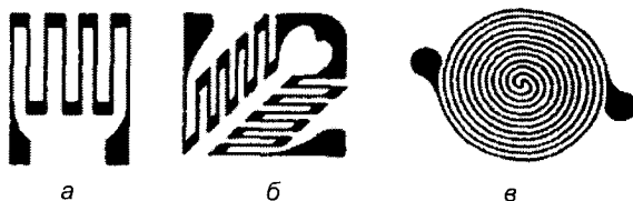
Рис. 5.6. Фольгові тензодатчики для виміру: а – лінійних переміщень; б – деформацій в двох взаємно перпендикулярних напрямках; в – тиску
