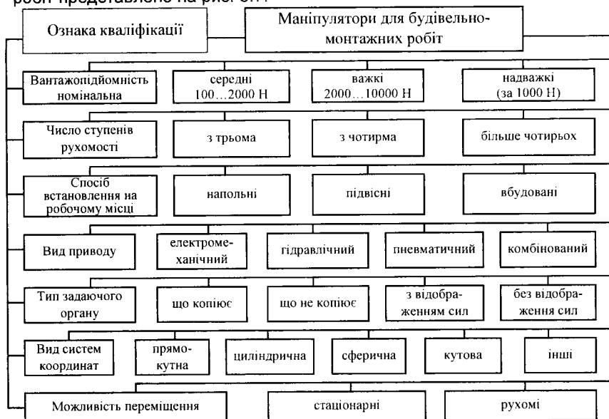
Рис. 3.7. Класифікація маніпуляторів для будівельно-монтажних робіт
