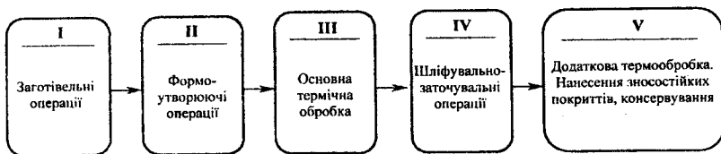
Рис. 9.4.Схема технологічного процесу виготовлення інструментів
