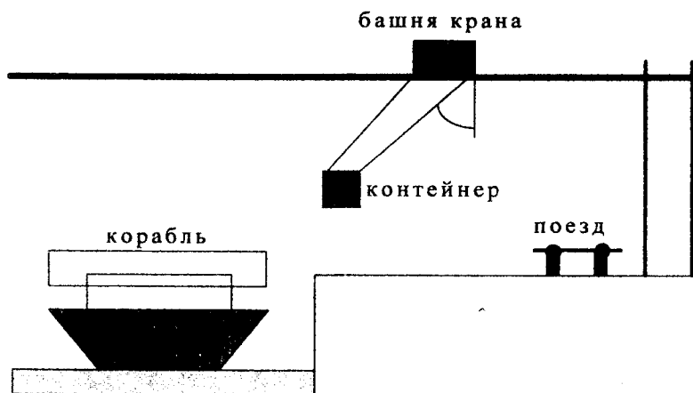
Рис. 2.1. Процесс погрузки контейнерным краном
