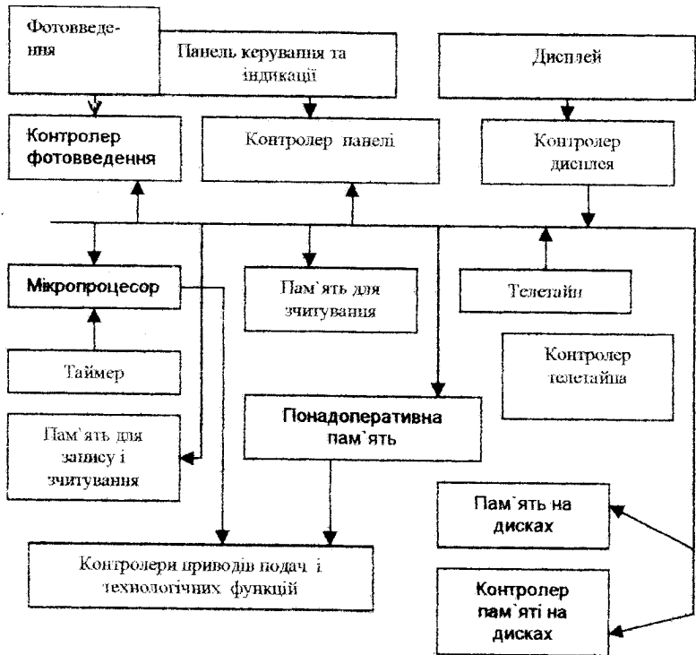
Рисунок 2.4—Структурна схема системи ЧПК, побудованої на базі EOM
