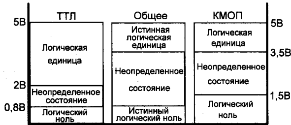
Рис. 2.1. Обобщенные диапазоны входных напряжений ТТЛ и КМОП-микросхем
