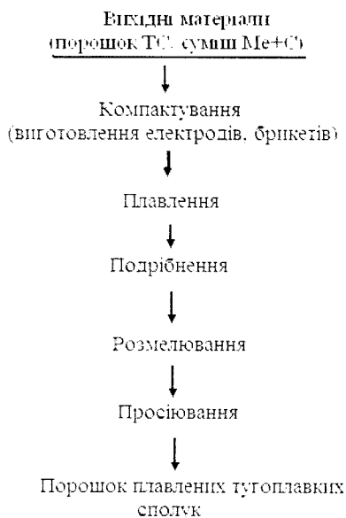
Рисунок 30 – Узагальнена технологічна схема отримання порошків плавлених тугоплавких сполук
